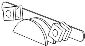
**3** Choisir la forme et les supports de cintrage correspondant au diamètre du tube.
