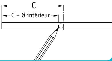
**1** En fonction de la cote A à respecter (distance entre l'extrémité du tube et le mur), calculer la cote C.
