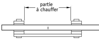
**4** Recuire le tube si nécessaire sur une distance correspondant à l'écartement des deux supports de cintrage.
