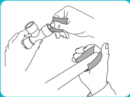
**1** Nettoyer les parties mâle et femelle à assembler à l'aide d'un tampon abrasif.
