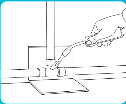
**3** Avant de braser un tube sur un mur, protéger celui-ci avec un pare-flamme.
