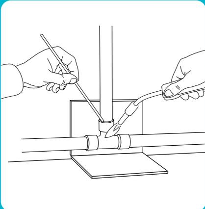
**5** Positionner la baguette dans l'intervalle des pièces à assembler afin d'obtenir une aspiration de la brasure par capillarité.
